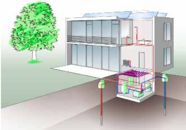
Grundwasserwärmepumpe mit zwei Brunnen
