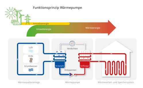
Eine erdgekoppelte Wärmepumpen-Heizungsanlage besteht aus drei Teilen: der Erdwärmequellenanlage, die dem Untergrund die benötigte Energie entzieht, der eigentlichen Wärmepumpe, die die gewonnene Erdwärme nutzbar macht sowie dem Wärmeverteil- und Speichersystem, das die Wärme im Haus verteilt oder zwischenspeichert.
