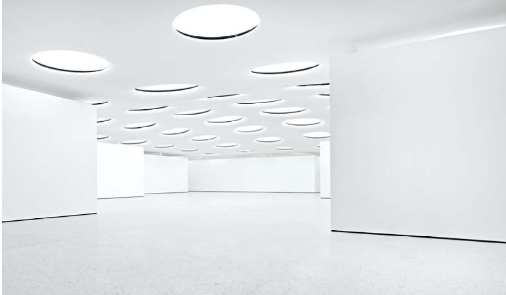
0602_Städel Museum Frankfurt am Main: Knapp 3000 qm zusätzliche Ausstellungsfläche wurden unter dem Garten des traditionsreichen Museum geschaffen. Die 195 Oberlichter versorgen die Halle mit natürlichem Licht.
