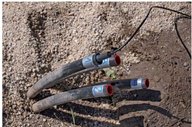
Befahren der Sondenrohre zur Messung der Bohrlochverfüllung.
