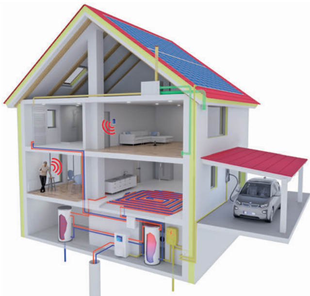
Photovoltaiksystem mit Wärmepumpe zur Strom- und Wärmeversorgung mit Batteriespeicher, Warmwasserspeicher.
